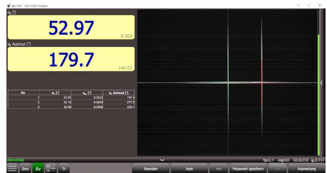
Bild: Applikation Keil-Winkelermessung über Doppelkreuz
