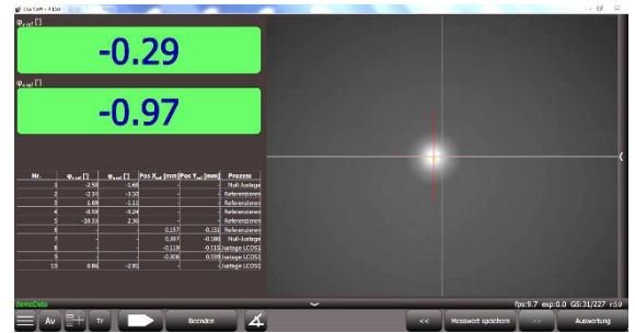
Bild: Winkelmessung mit Planspiegel + Toleranzkreis
