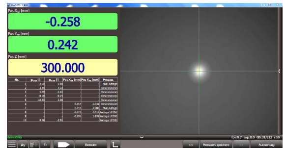
Bild: Positionsmessung mit Tripelreflektor oder Linse
