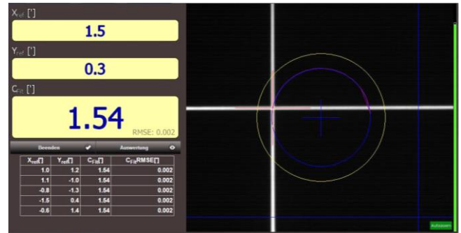
Bild: Applikation Zentriermessung mit Toleranzkreis
